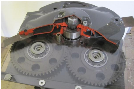
Figur 4. Rotorbalk och tallrik i genomskärning.
