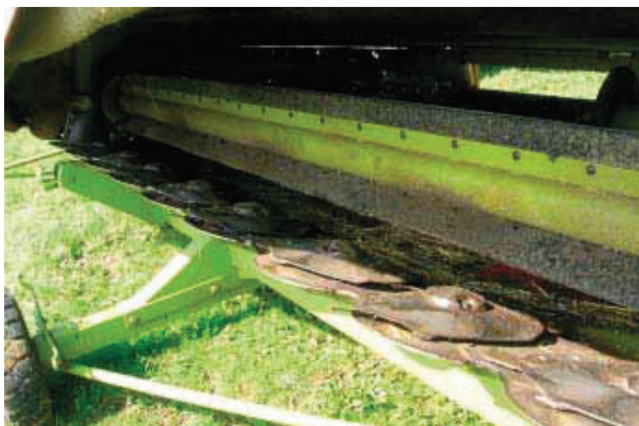
Bild 2. Helsädesbord till självgående hack kan minska spillet till nästa noll.
