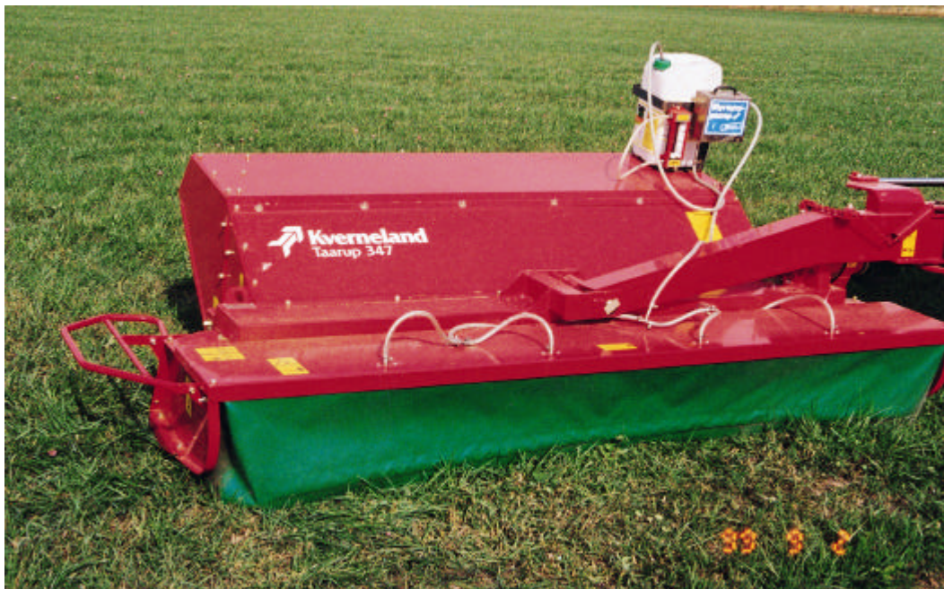
Bild 1. På slåtterkrossen som användes i försöken monterades fyra munstycken i plåthuven framför rotorbalen.
