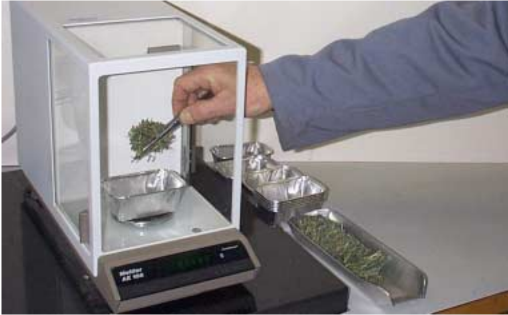
Bild 5. Invägning av delprov vid studierna av torkningsjämnhet.
