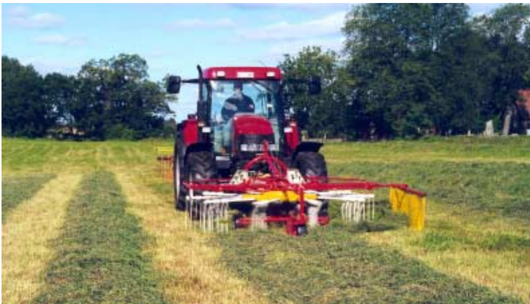
Bild 1. Genom att använda en frontmonterad strängläggare kan man undvika att köra i bredspriden grönmassa vid strängläggning.
