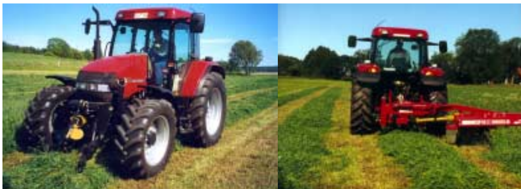
Bild 3. Vid slåtter av konventionella strängar grenslar traktorn strängen från föregående drag.
