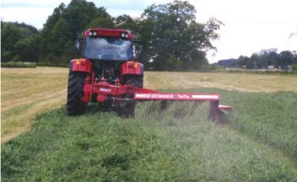
Bild 2. Vid slåtter med bredspridning kommer det ena hjulparet att gå i grönmassan från föregående slåtterdrag.
