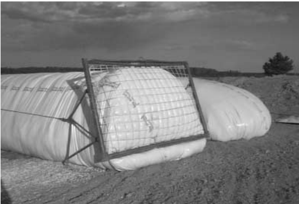
Bild 3. Vajrarna på packaren är infästa i en grind som fungerar som mothåll vid fyllningen.
