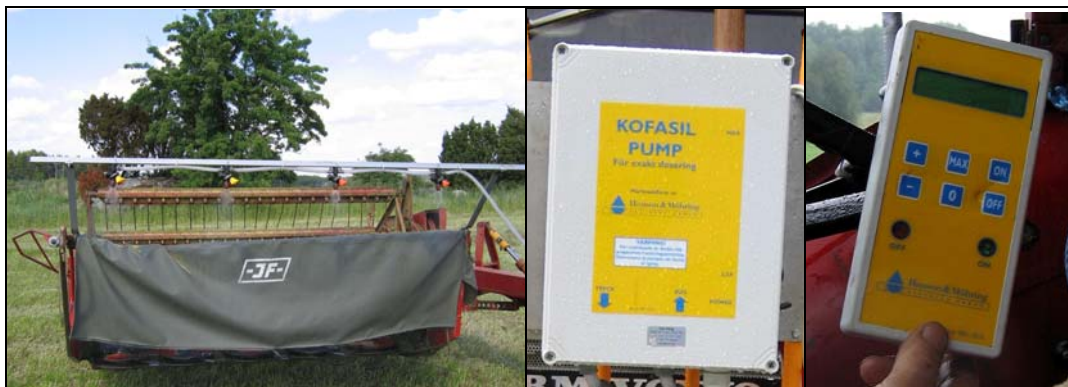
Bild 1. Doseringsutrustningen som användes i försöken bestod av en spruttramp med munstycken, doseringspump samt manöverenhet.
