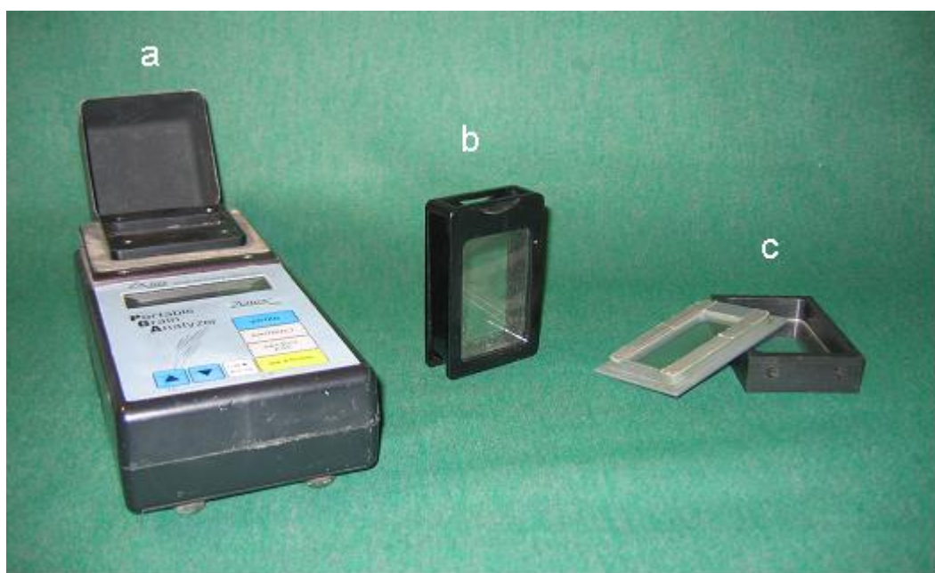
Figur 2. a) NIT-instrument, b) standardmätkammare för spannmål, c) modifierad mätkammare för ensilage. Foto: Martin Sundberg
