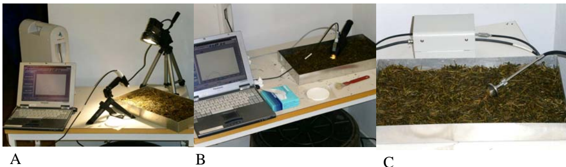
Figur 1. Tre olika uppställningar/prober som jämfördes. Fjärranalys med bar fiber (mätarean 25 cm 2 ) (A), kontaktprob med sammanbyggd lampa och fiberoptisk prob (0,5 cm 2 ) (B) och Trumpet spacer med fiberoptisk prob sammanflätad med fiberoptisk ljuskälla (0,05 cm 2 ) (C). Foto: Bo Stenberg
