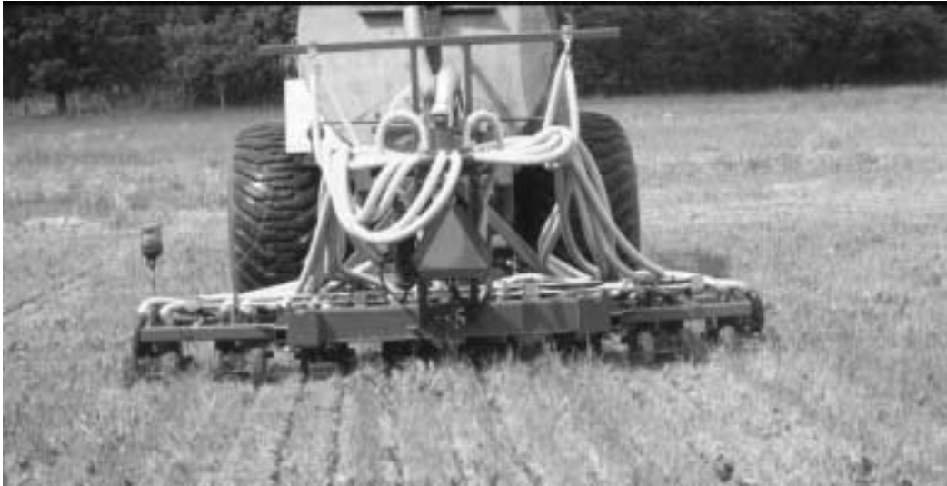
Bild 2. Fullskaletankvagn med en 4 m bred ramp, prototyp 2. Foto: Lena Rodhe.
