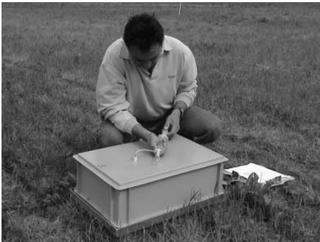
Bild 7. Gasprov sugts ur den slutna kammaren vid förslutning (tid 0), 30 och 60 min efter förslutning. Utifrån koncentrationshöjningen i kammaren beräknas emissionen per yta och tidsenhet.
