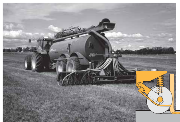
Spridare 3. Öppen ytmyllning, två vinkelställda skivor (Samson)
