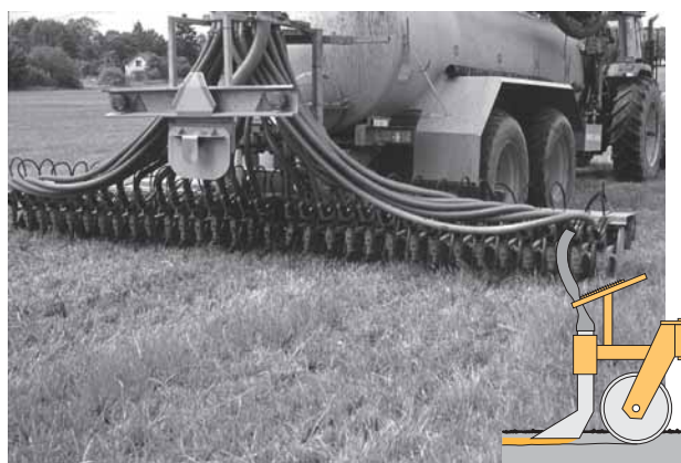
Spridare 2. Öppen ytmyllning, V-formad skivbill (JAKO)
