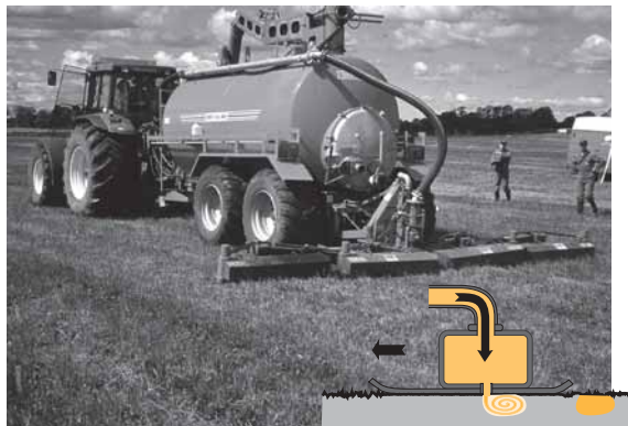
Spridare 1. Ytmyllning, gödselstråle med högt tryck (DGI)
