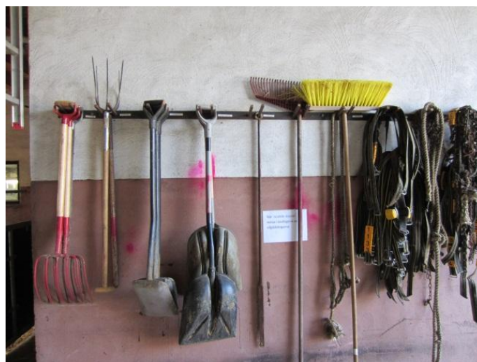
Bild 15. En välorganiserad arbetsplats. Innan visste man aldrig var sopborsten fanns, vilket orsakade irritation och onödigt tidssvinn. I ett 5S-projekt funderade man på vilka redskap som behövdes i ligghallen och var det bästa stället var att placera dem. Resultatet blev denna enkla redskapshängare. Ordningen upprätthålls genom att genomföra revisioner, vilket tränar människor i att ta ansvar för sin arbetsplats och göra uppföljningar.
