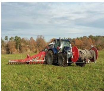
Bild 18. Med ett materslangsystem går det att minska markpackningen jämfört med att köra med en tankvagn. Foto: Christer Johansson
