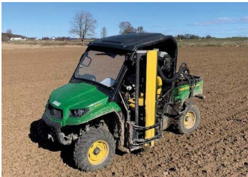
Bild 1. Oftast tas jordprover vid markkartering med jordborr som är monterad på en fyrhjulning. Provpplatsernas positioner fastställs med GPS. Foto: Magnus Westöö
